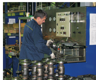
Тестирование шаровых кранов
